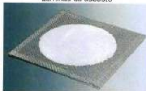
Rejilla de asbesto
